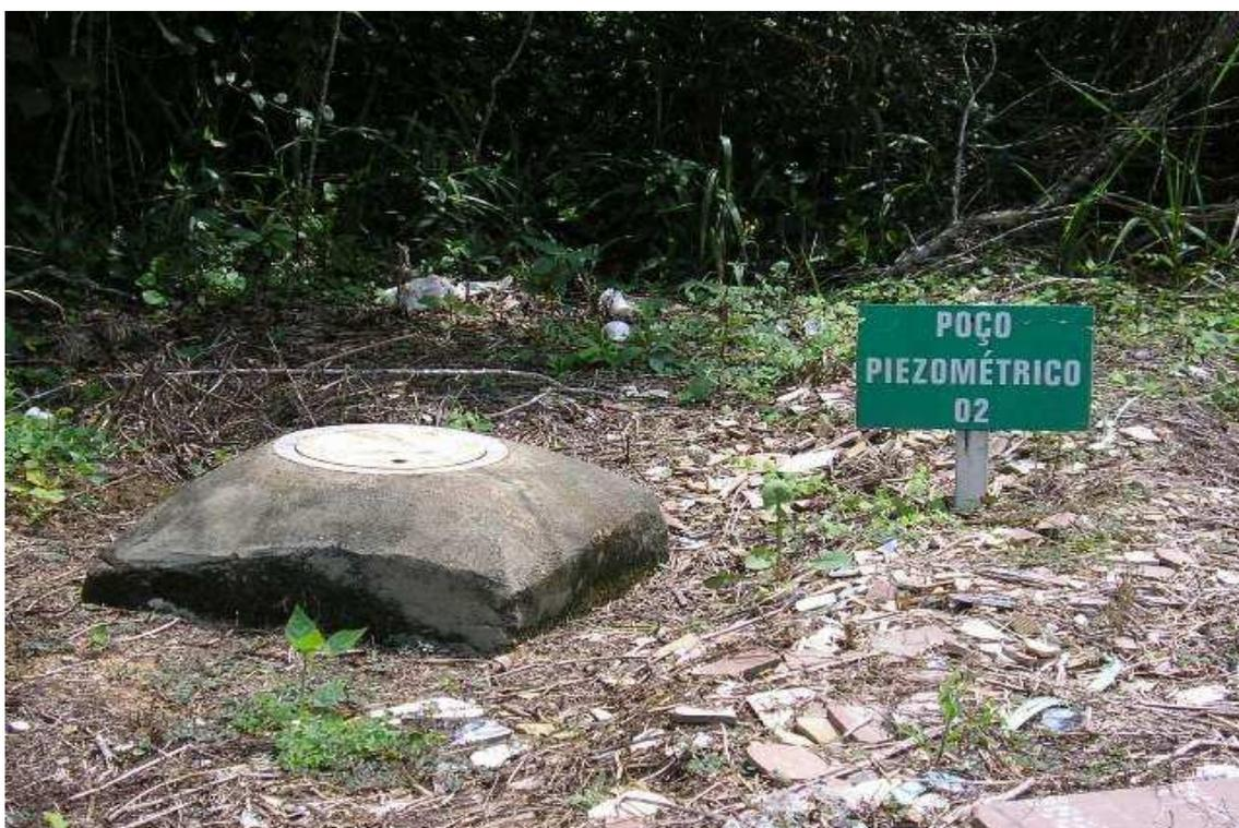
FIGURA 07: Poço piezométrico (PZ-02). Fonte: Ross, E., 2007
