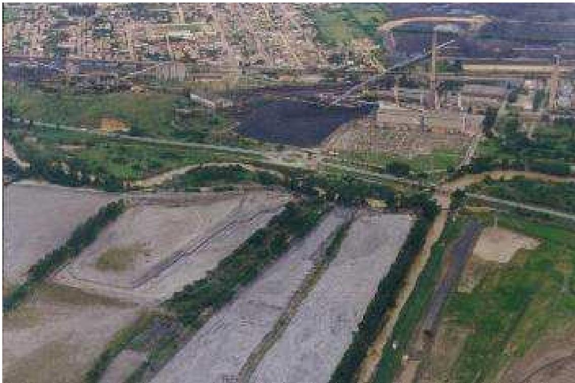
Figura 17: Aterros de cinzas localizados no entorno de uma usina termoeletrica localizada na região Sul de Santa Catarina. Fonte: Milioli, 1999
