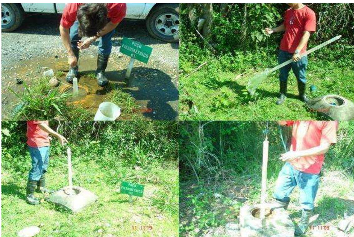
Figura 22: Atividades de limpeza e coleta das amostras de água nos piezômetros 1, 2 e 3. Fonte: Ross, E., 2007.
